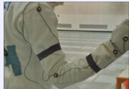
Schnelligkeits- u. Technikdiagnostik: 2 Kameraeinheiten mit je 3 IR-Kameras registrieren die Position der 16 aktiven Infrarot-Marker, die am Athleten befestigt sind. Datenübertragung und Stromversorgung kabellos.
