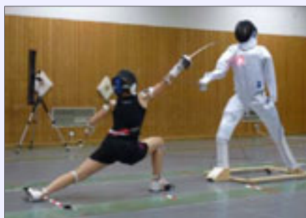
Schnelligkeits- u. Technikdiagnostik: Fechtdummy mit Trefferflächen integriert in ein 3D-Motion-Capute-System (2000Hz, Lukotronic, Austria). Im Hintergrund: transportable Kameraeinheit mit Infrarot-Kameras.
